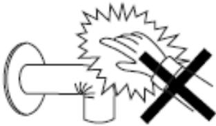
En días muy fríos o de alta temperatura, el aparato expulsa vapor de la Salida de humos. Esto es normal debido a la alta eficiencia del aparato y no indica ningún tipo de fallo.
