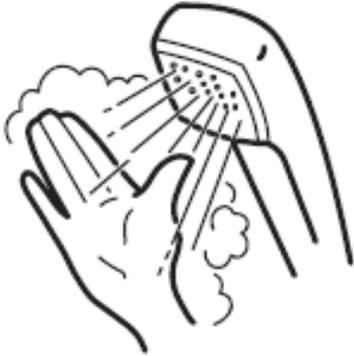
A bajos caudales de agua, la unidad de agua caliente puede apagarse sin previo aviso.
