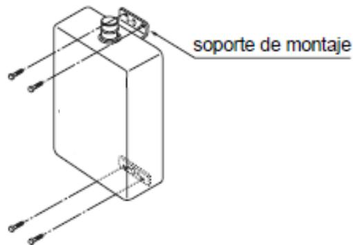
4) Asegúrese de que el calentador se instala en una pared vertical.
