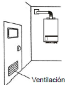
6) La habitación donde está instalado el calentador deberá ser ventilada para asegurar un buen rendimiento y seguridad a sus familias. Apertura de área de tamaño de ventilación para cada unidad debería ser más que el área del diámetro de la terminal de combustión.
