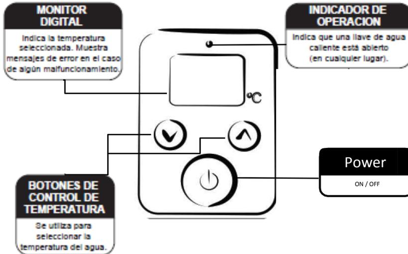
El propósito de los controladores de temperatura es permitir al usuario tener un control completo sobre el calentador. Usados correctamente, el calentador suministrará agua caliente a la temperatura seleccionada, incluso cuando el flujo de agua varíe o cuando más de una llave se utiliza.
