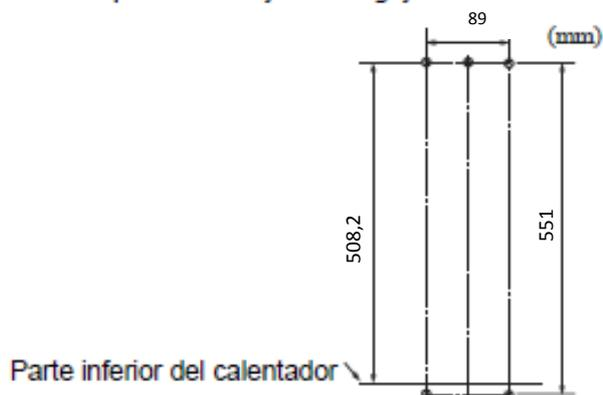
Tamaño del orificio es de un diámetro de 7mm y de 30-35mm de profundidad.
