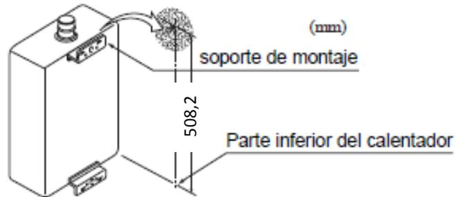
3) Fijar el calentador atomillando desde la parte superior a inferior los 2 tornillos correspondientes al calentador
