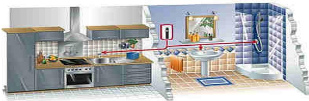
No acumula agua caliente que hay que volver a calentar cuando baja su temperatura, como en los termo tanques tradicionales, y tampoco necesita de una llama piloto que esté permanentemente encendida como en los de gas.
