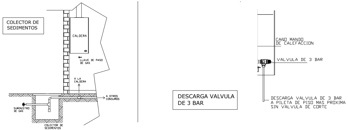
Figura II k: Colector de sedimentos y descarga de Valvula de 3 bar
