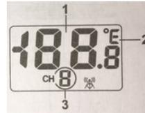
(1) Indicador de temperatura, (2) Unidad de medición °F y °C, (3) Canal establecido (CH1).
