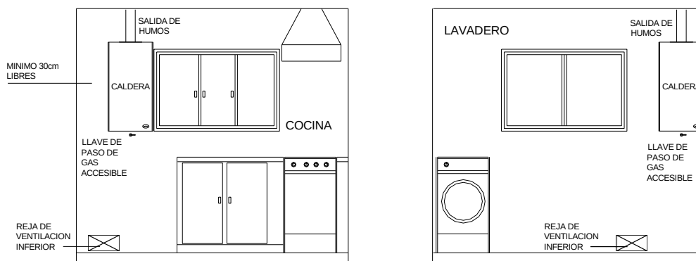
Figura II i - Esquema instalación de caldera mural dentro de la cocina o de un lavadero
