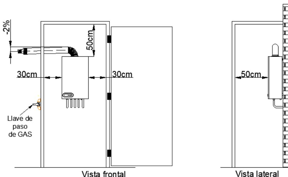
En caso de instalar la caldera dentro de un gabinete el mismo debe cumplir con las disposiciones de ENARGAS tanto provinciales como Municipales. Las paredes del mismo deben ser de material incombustible y contar con la ventilación correspondiente según la normativa vigente. La llave de corte de gas debe estar fuera del mismo en un lugar visible, accesible y de fácil manejo.
